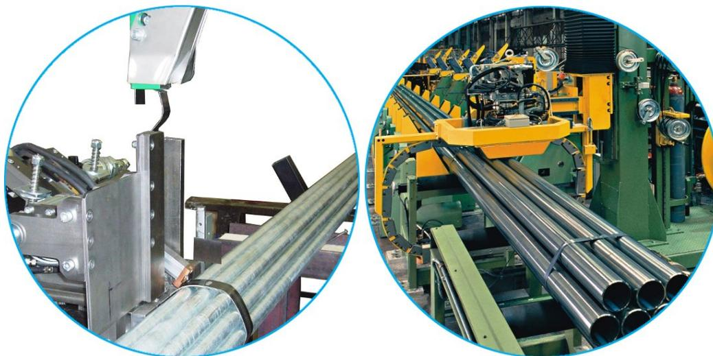
**Testata di sigillatura a funzionamento elettro-pneumatico per la reggiatura di fasci fino ad un diametro di 10 cm. Il sistema di chiusura avviene attraverso processo di saldatura su due punti.**
