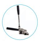
Il tenditore è ideale per il serraggio del sistema nastri e graffe in acciaio inox con larghezza banda da 6.30mm (1/4") a 19.00mm (3/4"). Ha la funzione di tirare il nastro, dopo averla inserita nella fibbia, fino ad un punto di tensionamento determinato; a questo punto la fibbia trattiene il natro in posizione e con l'utensile si taglia il nastro in eccedenza.
