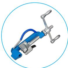
Il tenditore è ideale per il serraggio del sistema nastri e graffe in acciaio inox con larghezza banda da 6.30 mm (1/4") a 19.00 mm (3/4"). Ha la funzione di tirare il nastro, dopo averla inserita nella fibbia, fino ad un punto di tensionamento determinato; a questo punto la fibbia trattiene il nastro in posizione e con l'utensile si taglia il nastro in eccedenza.
