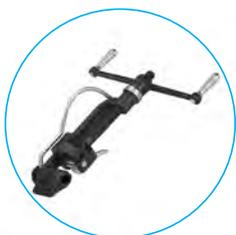
Il tenditore è ideale per il serraggio del sistema nastri e graffe in acciaio inox con larghezza banda da 19,10 mm (3/4") a 31.80 mm (1"-1/4"). Ha la funzione di tirare il nastro, dopo averla inserita nella fibbia, fino ad un punto di tensionamento determinato; a questo punto la fibbia trattiene il nastro in posizione e con l'utensile si taglia il nastro in eccedenza.
