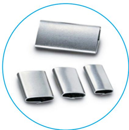
Nel sigillo overlap la reggetta inox viene inserita nel sigillo prima del tensionamento. Il caratteristico bordo sovrapposto fornisce il necessario sostegno quando il tenditore spinge contro il bordo della reggetta.
