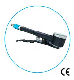
Il modello **hi-flow ht** rappresenta la soluzione ottimale per gonfiare i "dunnage bags" nel minor tempo possibile. Sfruttando il principio di Venturi l'alimentazione dell' aria compressa inserita viene aumentata dall'utilizzo dell'aria esterna velocizzando il processo di gonfiaggio del cuscino.
