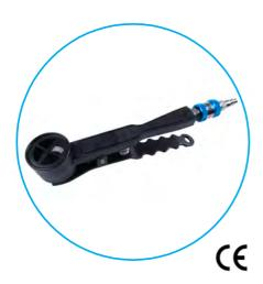
Il modello **basic** della serie **hi flow** rappresenta la soluzione ottimale per gonfiare i "dunnage bags" nel minor tempo possibile. Sfruttando il principio di Venturi l'alimentazione dell' aria compressa inserita viene aumentata dall'utilizzo dell'aria esterna velocizzando il processo di gonfiaggio del cuscino.
