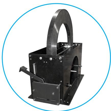
**dispensatore fisso** con solida struttura in acciaio, progettato per facilitare il taglio della bobina. Può contenere due bobine ribbon (monospira) o un rotolo di reggetta con avvolgimento oscillato. Ideale per reggette in acciaio e poliestere. Lama di taglio ad azionamento a pedale.
